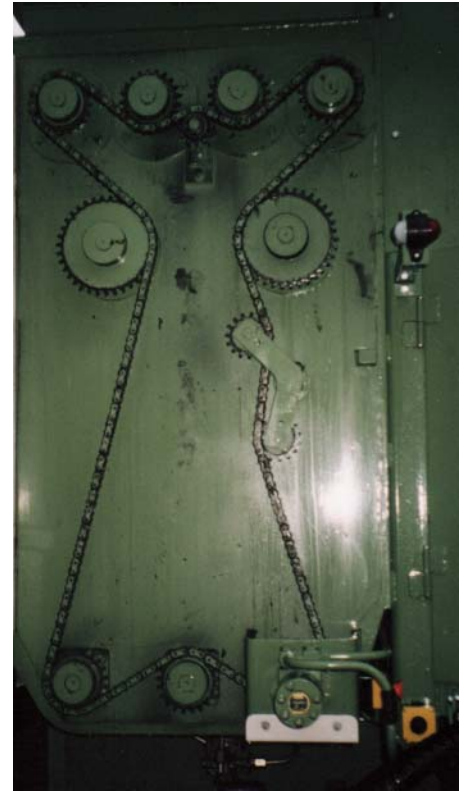
Tendeur «Boomerang» dans l'entraînement des vis sans fin
