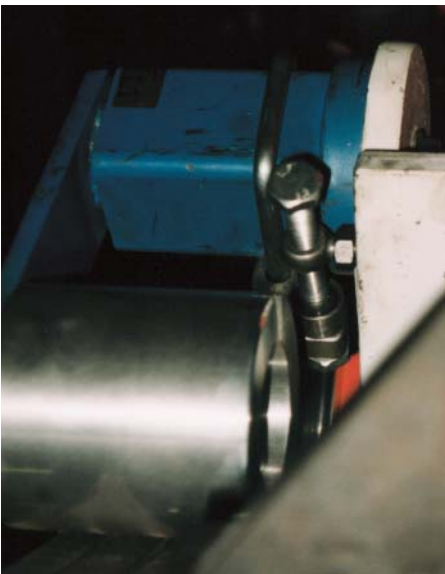
Tendeur SE 27 avec unité de pré-tension
