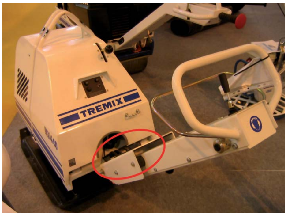
Suspension élastique des consoles de guidage du compacteur
