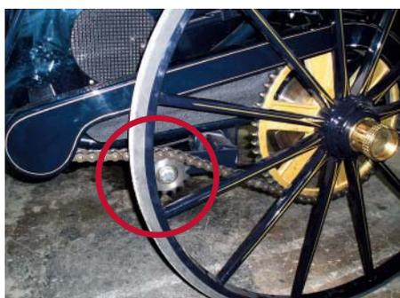
par des chaînes de 1". Ces dernières sont tendues par des tendeurs ROSTA de dimension SE 38. Les roues dentées sont montées en Z. Un angle de pré-tension d'env. 15° empêche le battement du brin lâche et compense le très haut couple de démarrage. Les roues dentées motrices et entraînées (rapport 1:70) ne présentent aucune usure même après 3 ans de conduite. Même la très longue
