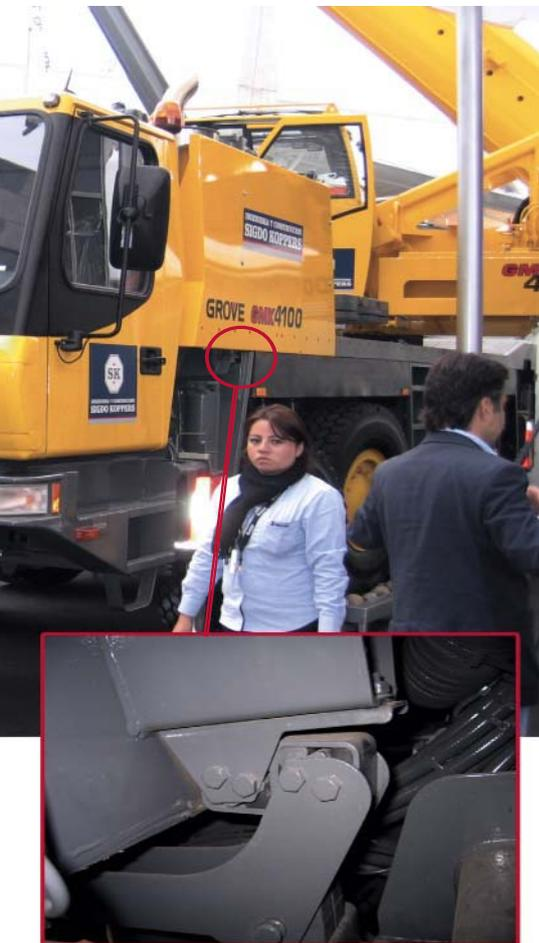
du véhicule, la cabine du conducteur reste en position absolument parallèle à la sous-structure du châssis en raison de l'axe Y beaucoup plus rigide des amortisseurs ROSTA.
