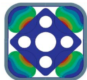
Analyse FEM d'un élément ROSTA en état de repos.
