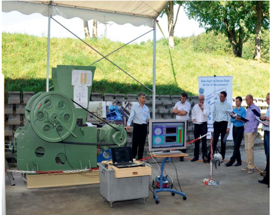
Moteur d'entraînement pour broyeur à mâchoires, suspendu élastiquement sur un MB 70x550
