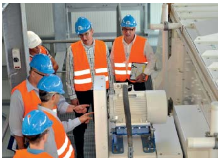
Est-ce que l'angle d'inclinaison choisi pour la bascule de moteur correspond bien au sens de rotation de l'entraînement?
