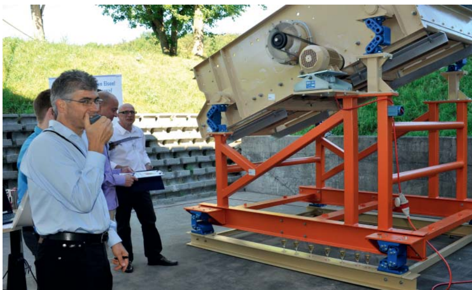
Contre-cadre oscillant (rouge) reposant sur des éléments oscillants du type AB-D 50
