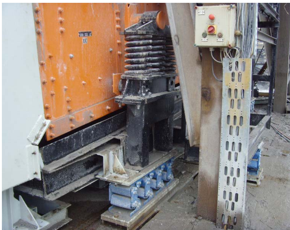
Crible LZG avec suspension sur ressorts hélicoïdaux, cadre contre-vibrant appuyé sur 14 éléments oscillants ROSTA de type AB-D 50-2
