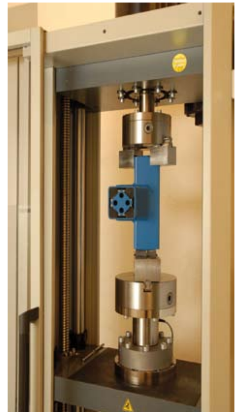
Machine de contrôle pour le couple dans le laboratoire de ROSTA
