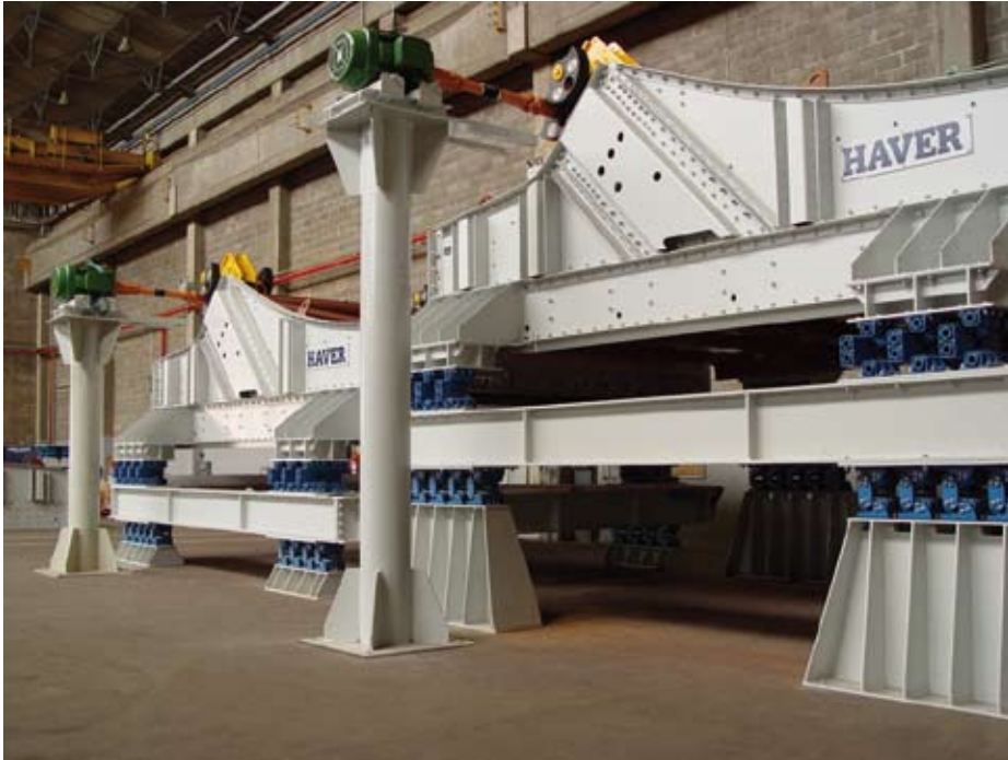
Tamis pour le minerai avec suspensions ROSTA
