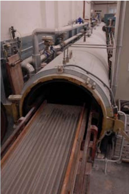
Vulcanisation des profilés dans l'autoclave
