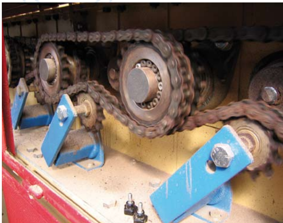
Transmission à chaîne avec tendeurs ROSTA
