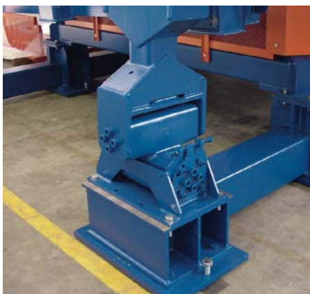
Palier d'appui de crible «Plansichter» avec joints articulés type AK 100-4
