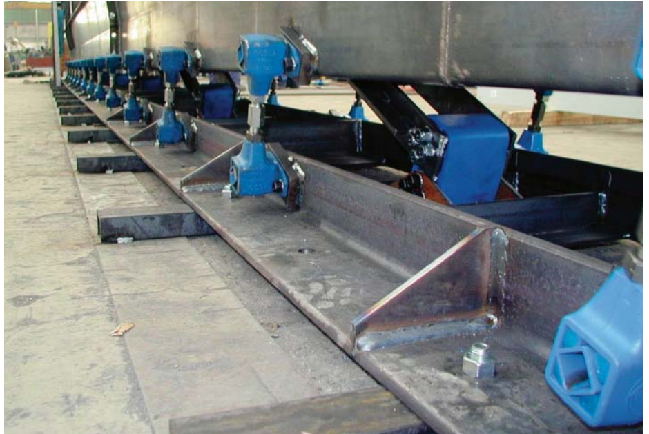
Goulotte à résonance à une masse pour pièces de fonte avec éléments oscillants type AU 45 et accumulateurs DO-A
