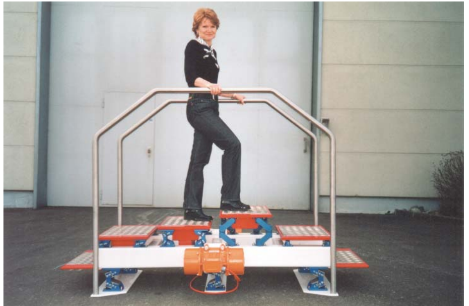
„Poutre vibrante“ munie d'amortisseurs de vibrations ROSTA
