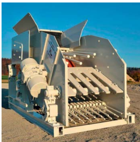
Côté sortie, le crible à barres avec sa cascade de barres et sa grille de séparation.
