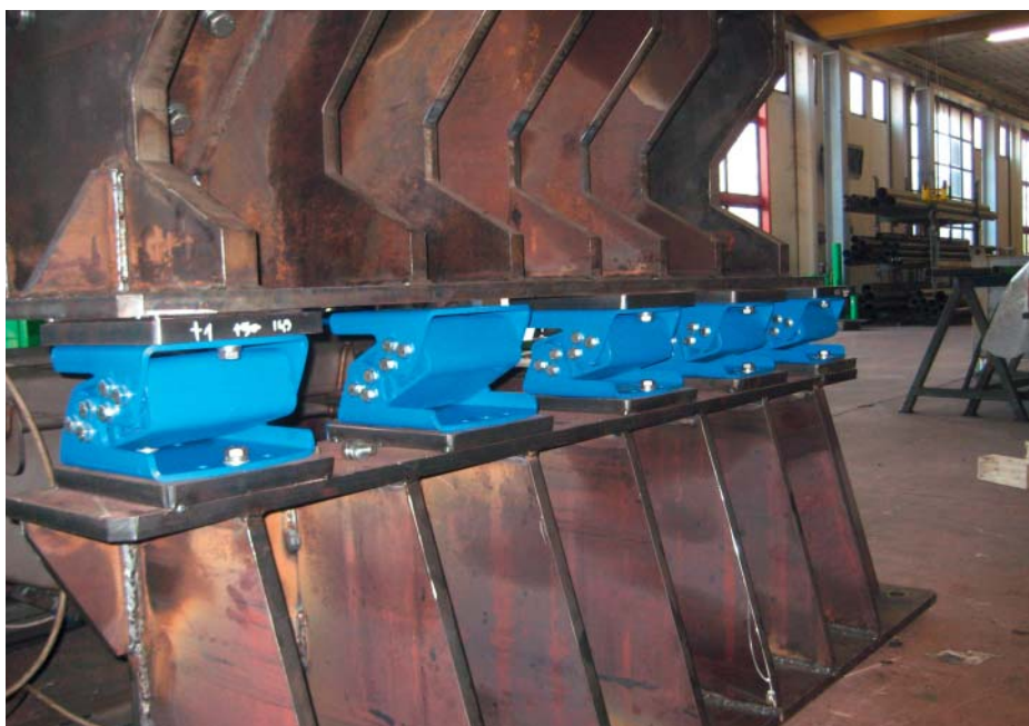
Vue détaillée de la suspension du broyeur à marteaux; grâce à la capacité de suspension élevée des amortisseurs de vibrations, pratiquement plus aucune vibration n'est mesurable sur le châssis de la machine.
