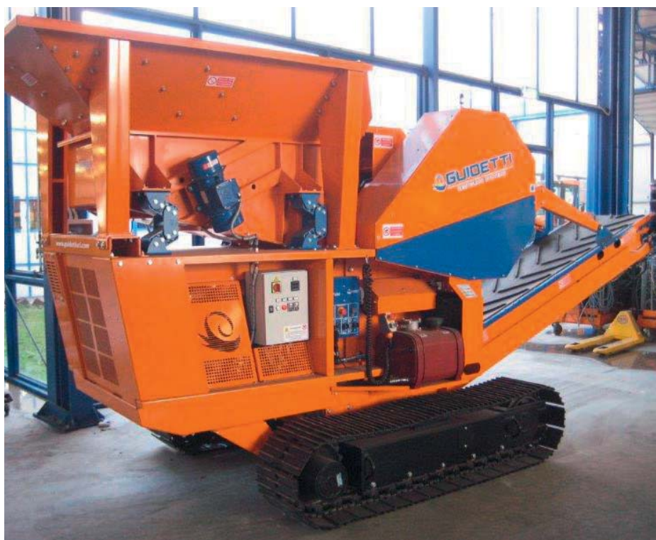
Concasseur mobile de gravats «Caesar-Junior» avec trémies de 2 m 3 , suspendu sur quatre éléments oscillants ROSTA type AB-D 50.
