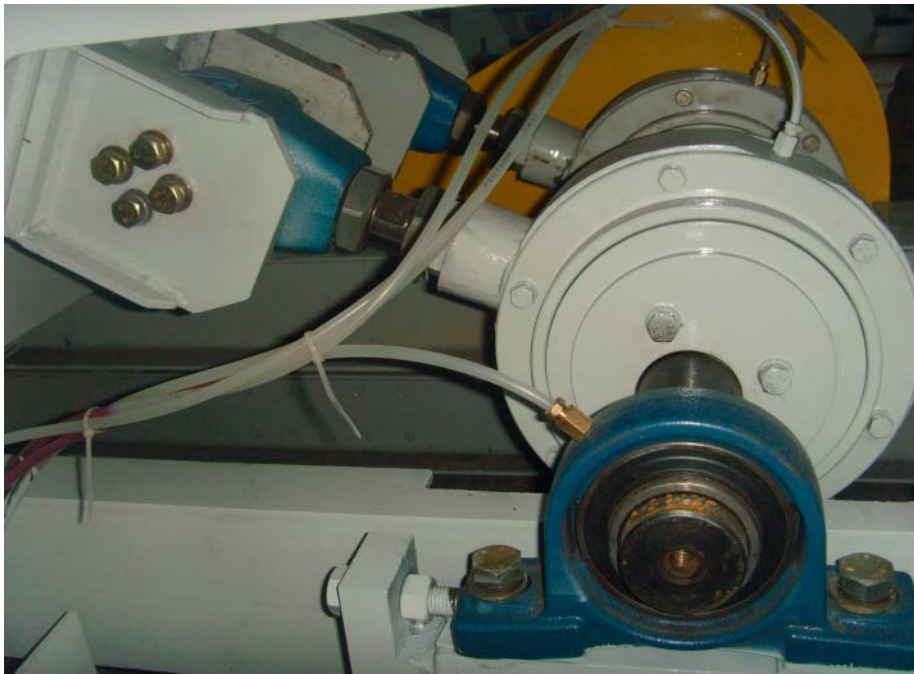
Entraînement de la bielle de poussée sur le convoyeur oscillant au moyen de deux têtes de bielle ROSTA type ST 50
