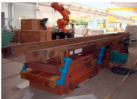
Prototype du nouveau concept de convoyeur oscillant comportant des éléments AD-P 50
