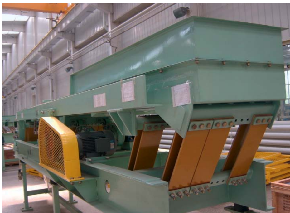
Le design d'origine de la machine oscillante avec des lamelles en fibres
