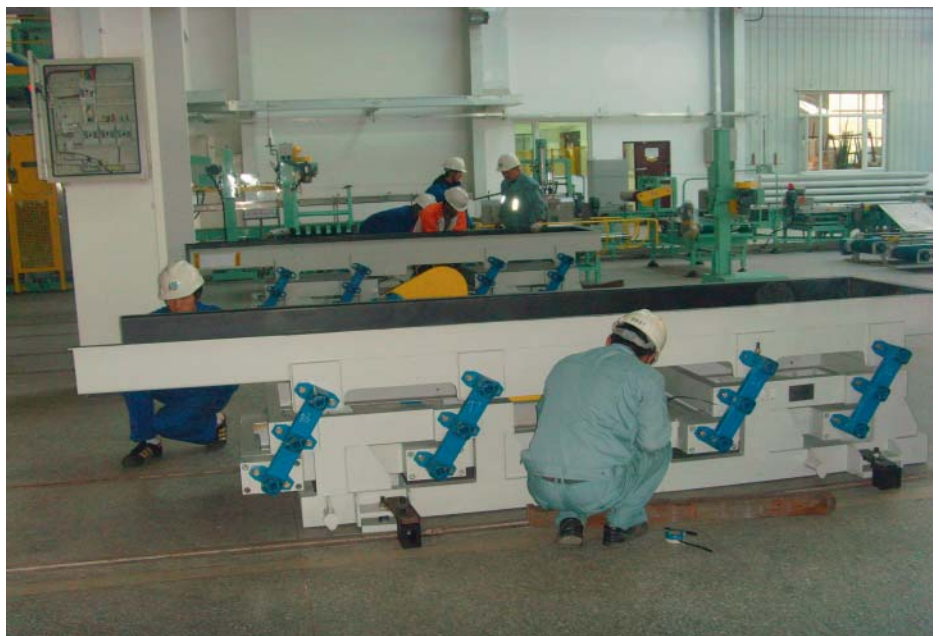
Fabrication en série de convoyeurs oscillants à deux masses chez Harbin Boshi
