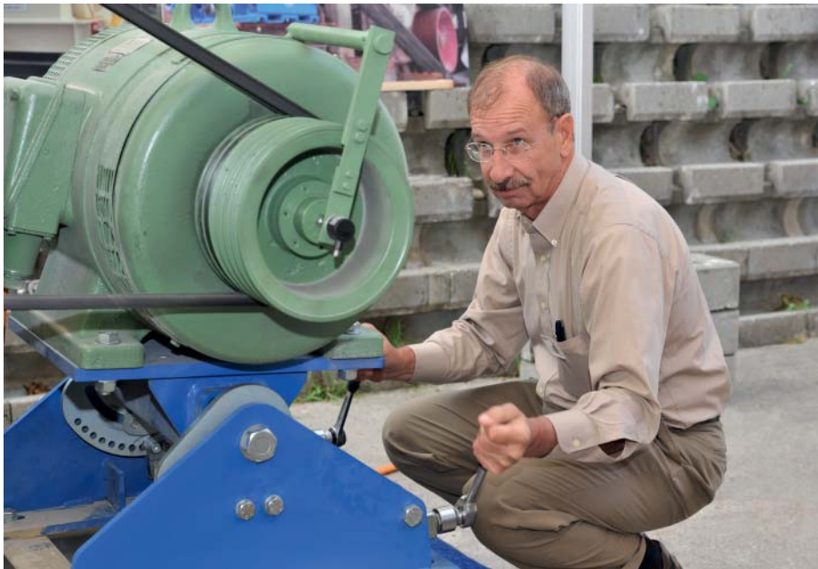
Système de réglage de la tension élémentaire avec deux cliquets de serrage
