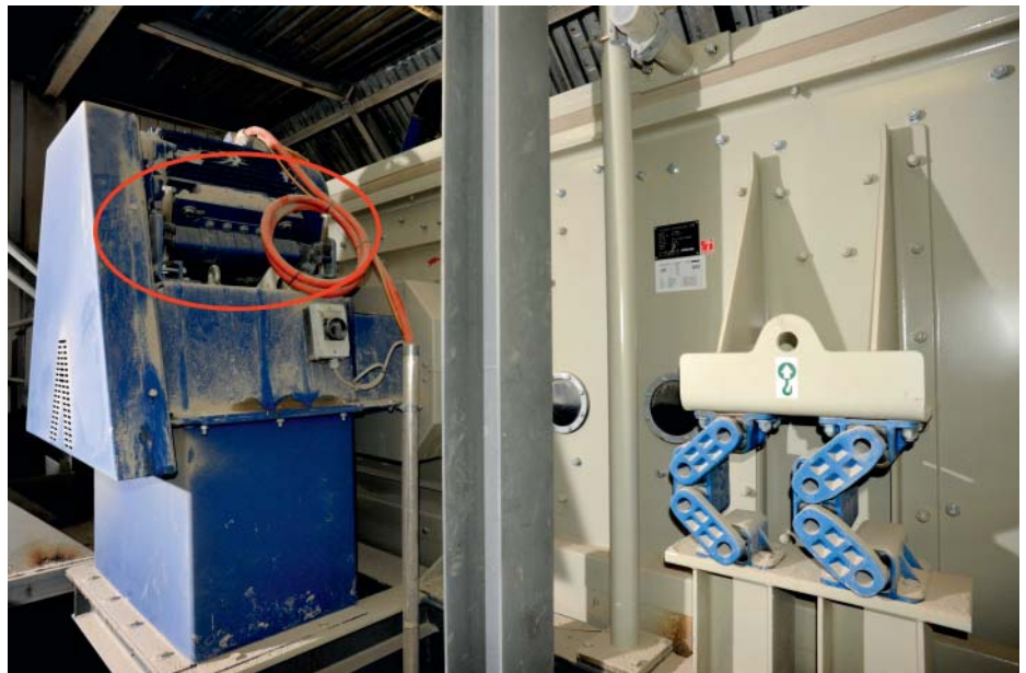
Entraînement par courroie monté sur bascule moteur type MB 50x270-2
