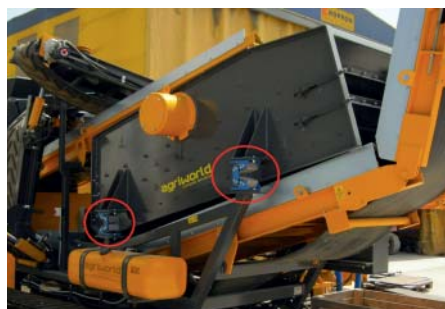
Crible mobile monté sur AB-D 38
