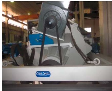
Transmission à courroie montée sur bascule moteur ROSTA, type MB 50x400
