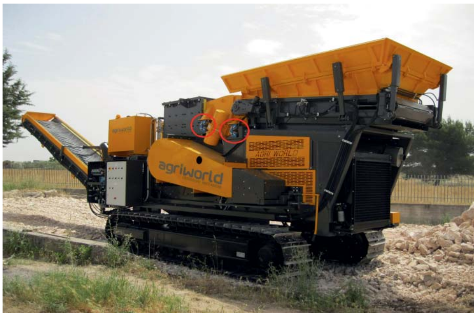
Concasseur mobile FM 9000.20, avec capacité 200 t/h
