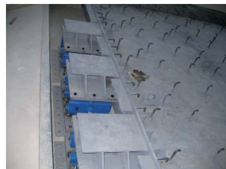
Socle massif: 6 x 9 mètres, Poids: 36 tonnes, supporté par 28 pcs. AB 50-2 TWIN
