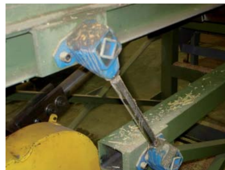
Nouveaux bras oscillants composés de deux AU 18
