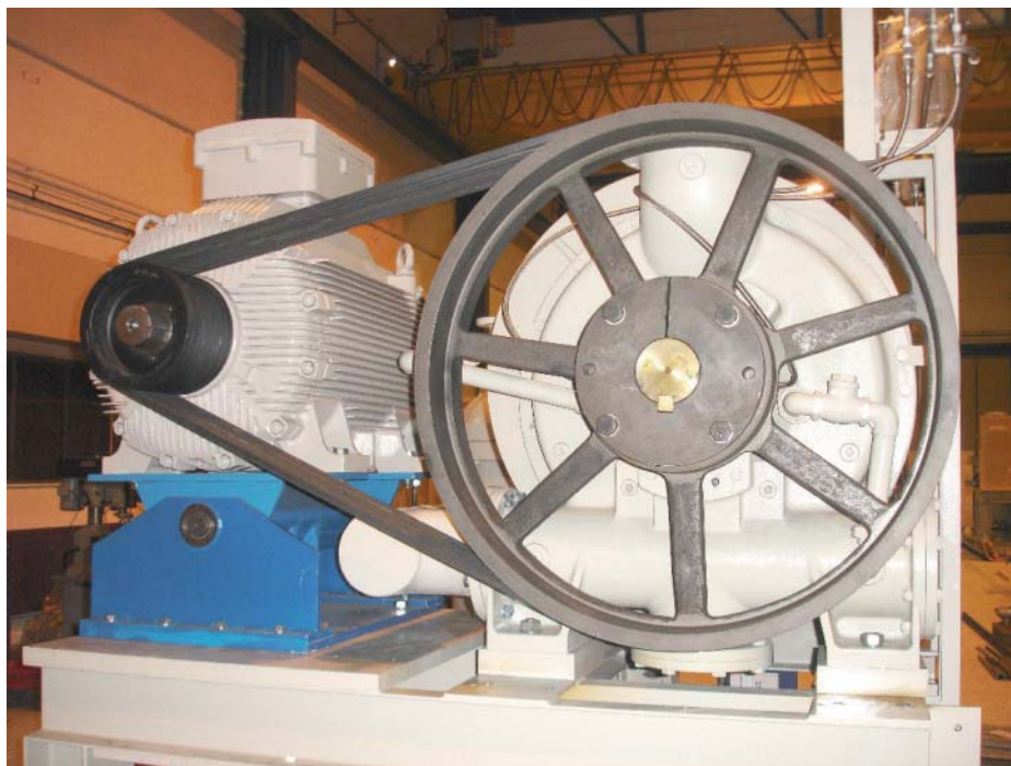
Moteur d'entraînement de 250 kW pour pompe à anneau liquide sur support à bascule ROSTA pour moteurs type MB 100
