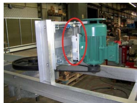
Transmission par courroie du ventilateur; moteur monté en position verticale sur support ROSTA, type MB 50 x 200
