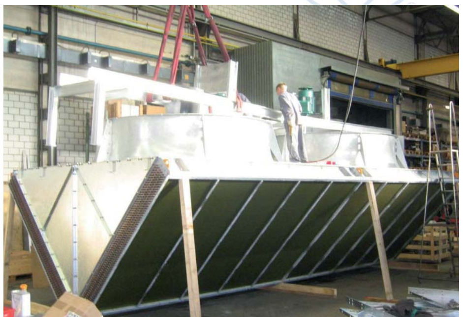
ECODYNE refroidisseur à double bloc (forme V) avec deux ventilateurs à pales pour la circulation effective de l'air
