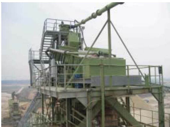
Fig. 2: Crible d'égouttage gravier avec contre-cadre vibrant sur ROSTA AB et AB-D
