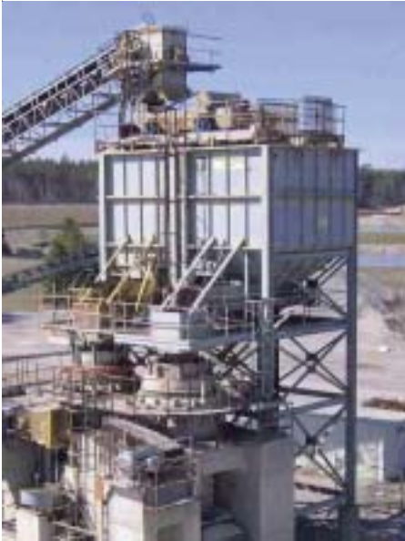
Fig. 1 : Cribleuse oscillante linéaire sur ROSTA AB dans une installation à structure métallique très élevée.
