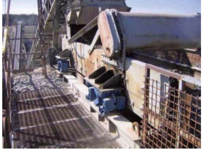
Fig. 1 : Cribleuse oscillante linéaire sur ROSTA AB dans une installation à structure métallique très élevée.
