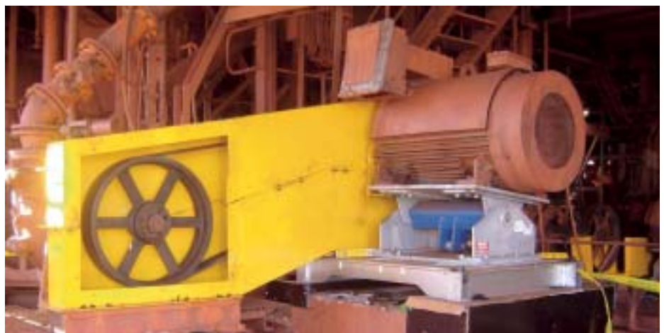
Socle-moteur à bascule ROSTA, type MB 100 avec moteur d'entraînement 220 kW pour pompe centrifuge Warman (Photo: BHP Billiton-Mining, Australie)
