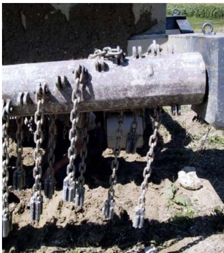
Rouleau à chaînes pour l'actionnement des mines
