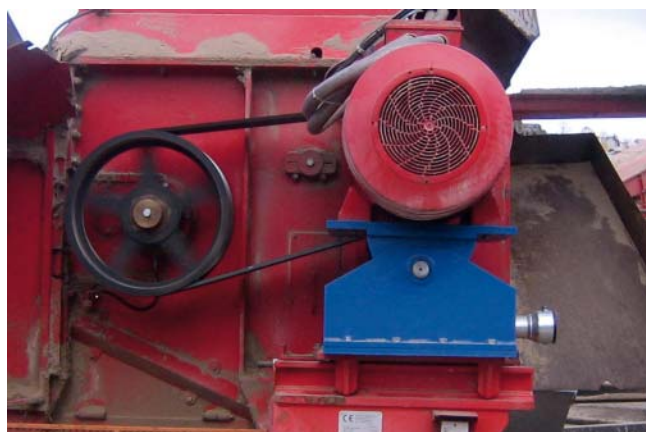
Compensation automatique de l'allongement des courroies
