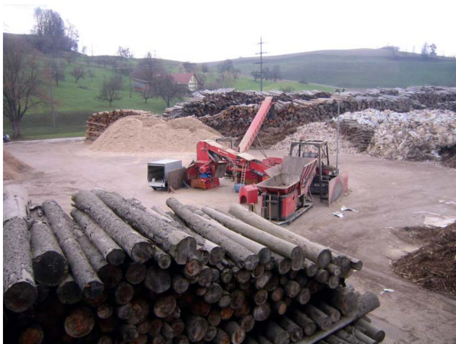
Déchiquteuse dans la fabrique de panneaux d'aggloméré
