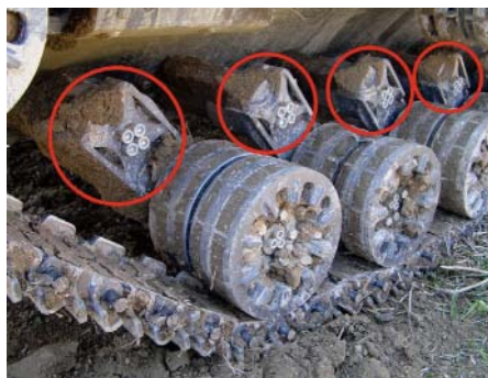
Suspension élastique ROSTA des galets guide-chaîne
