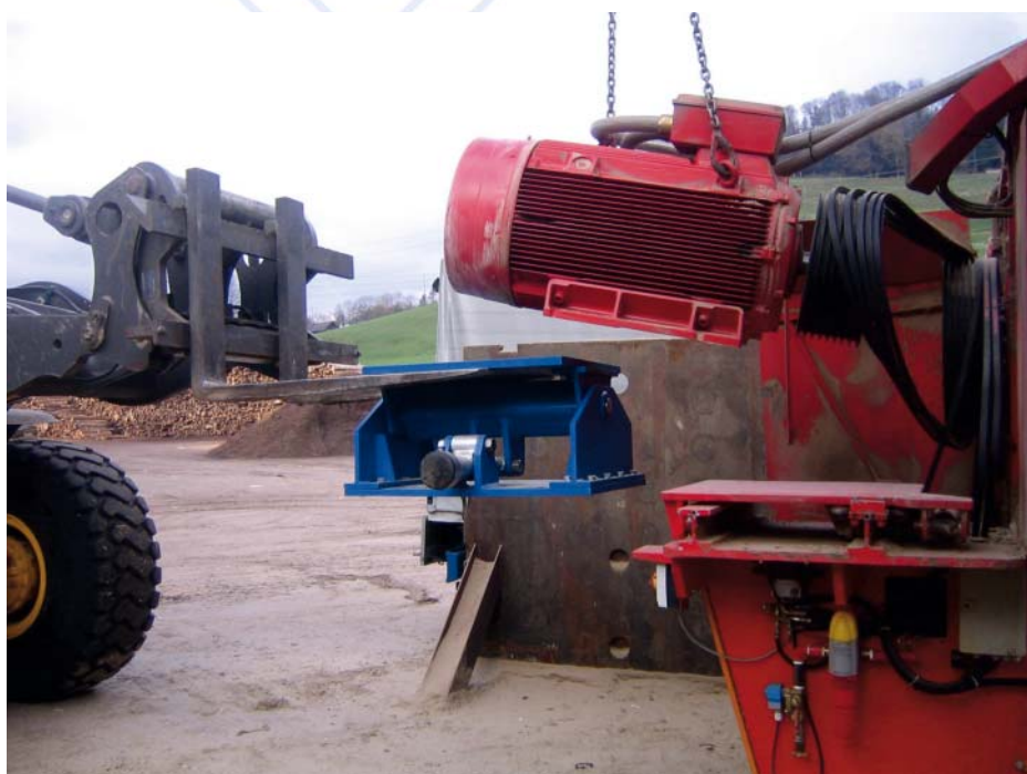
Montage d'un support à bascule type MB 100
