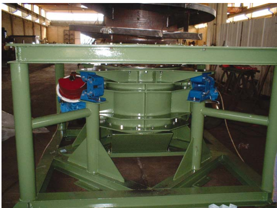
Entraînement au moyen de deux moteurs vibratoires VENANZETTI (Fig. 1)
