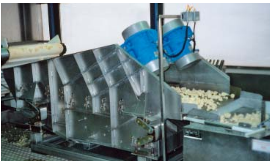
Crible de triage Superior, monté à l'origine sur 4 coussins à air «Air-Ball», réinstallé ultérieurement sur 4 éléments oscillants du type AB-45 (galvanisés).
