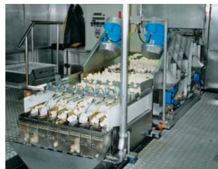
Conduit d'amenée et d'égouttage Lubbot-Wacker monté sur 4 éléments oscillants AB-45; équipé à l'origine de ressorts hélicoïdaux.
