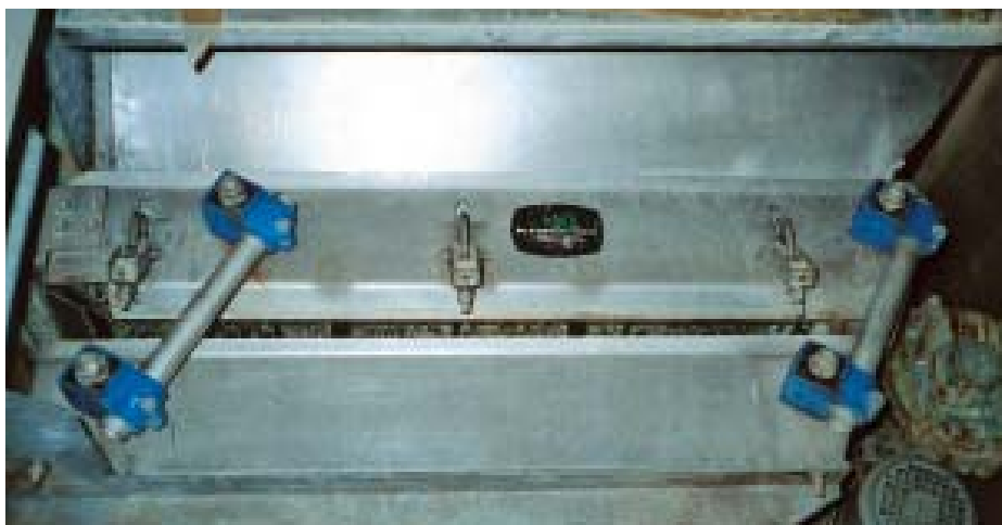
Key canal de dosage d'entrée logé à l'origine sur des lamelles en fibres 3M, remonté maintenant sur des bras oscillants ROSTA du type AR-38.
