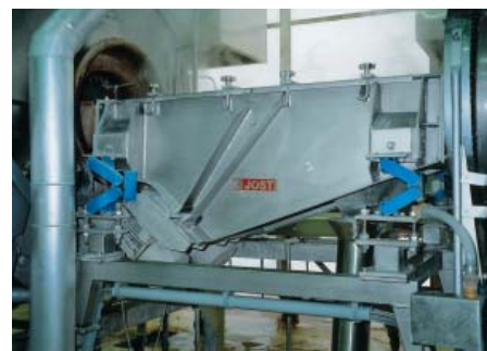
Secoueur de légume JÖST suspension sur ressorts hélicoïdaux remplacée par des éléments oscillants AB-38.
