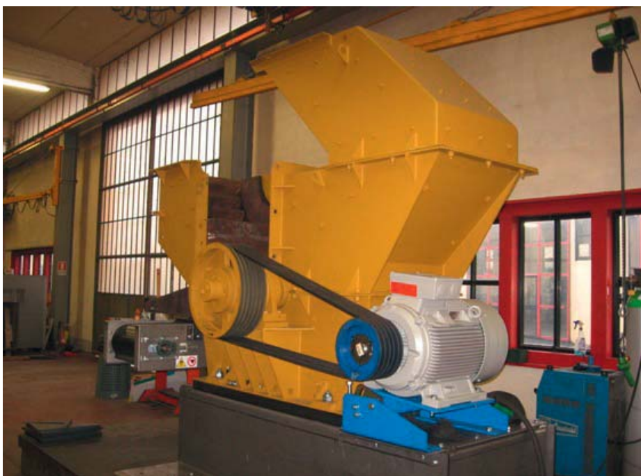
Frantumatore centrifugo, con motore da 45 kW taglia 225 M, 5 cinghie SPB, e Base Motore ROSTA MB 50 x 500
