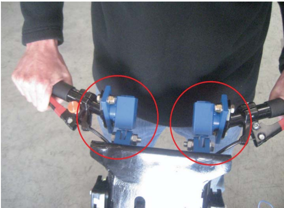
Isolamento dei manici in falciatrice a vite senza fine
