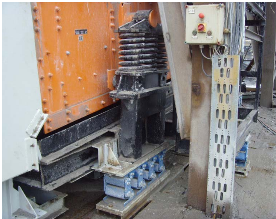
Vaglio LZG con sospensioni a molle elicoidali, e controltaio supportato da 14 Sospensioni ROSTA AB-D 50-2
