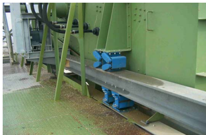
Vaglio vibrante Cyros su contromassa, montato all'altezza di 30 metri, nell'impianto di ghiaia di Welbers GmbH, DE-Kevelaer
