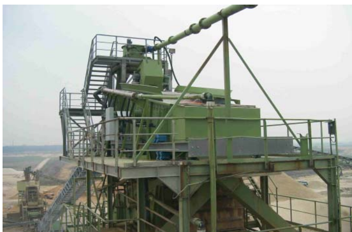
Vaglio vibrante Cyros su contromassa, montato all'altezza di 30 metri, nell'impianto di ghiaia di Welbers GmbH, DE-Kevelaer
