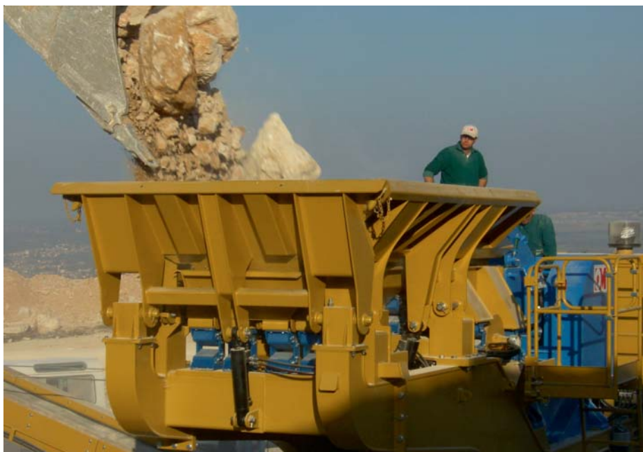
Alimentatore vibrante per gruppo mobile di frantumazione supportato su AB-D 50-2
