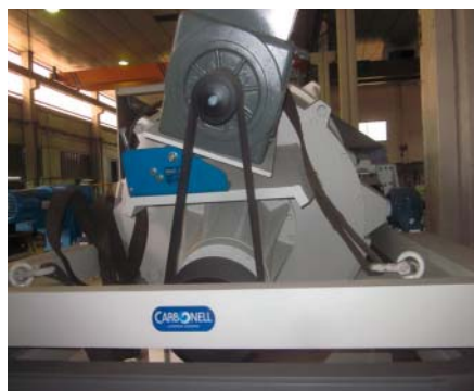
Motore per centrifuga installato su Base Motore MB 50x400
