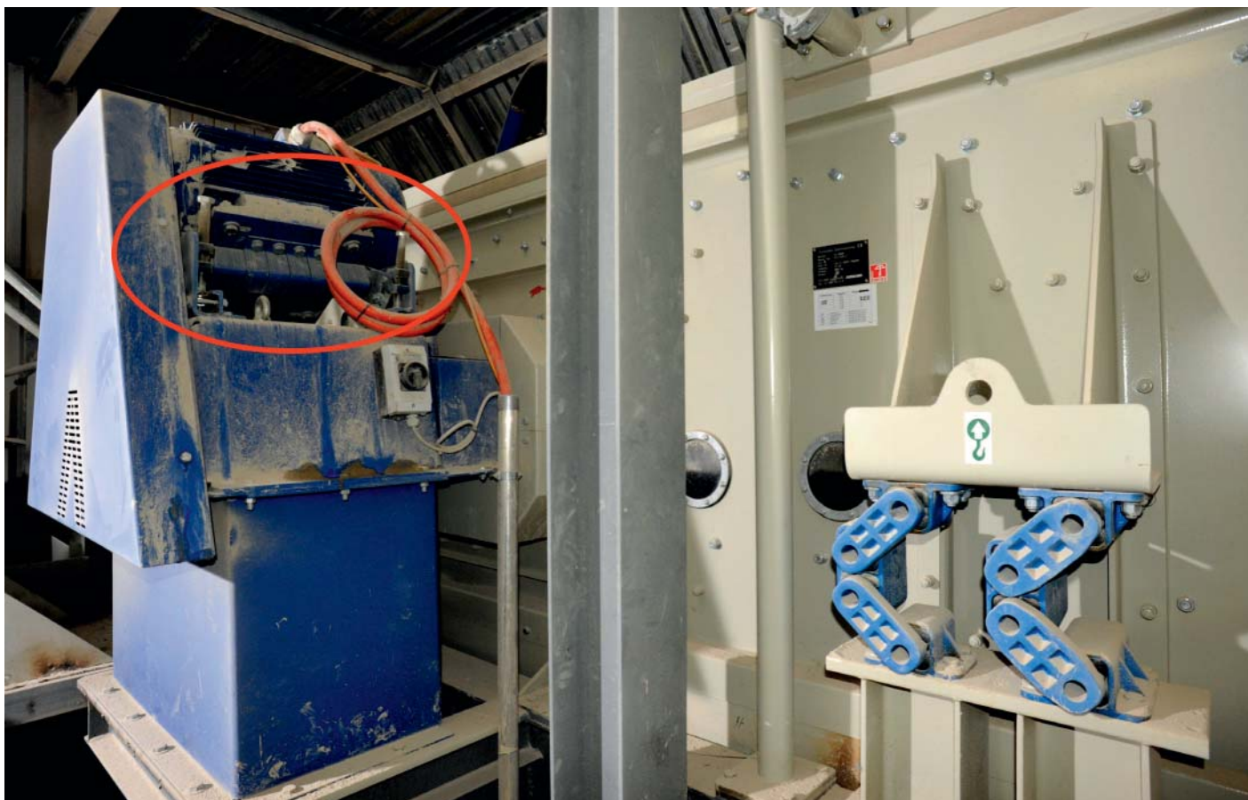
Motore per trasmissione a cinghia, installato su Base Motore tipo MB 50 x 270-2
