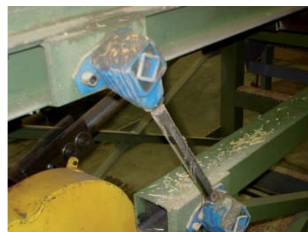
Nuovi supporti, composti da 2 elementi oscillanti tipo AU 18
