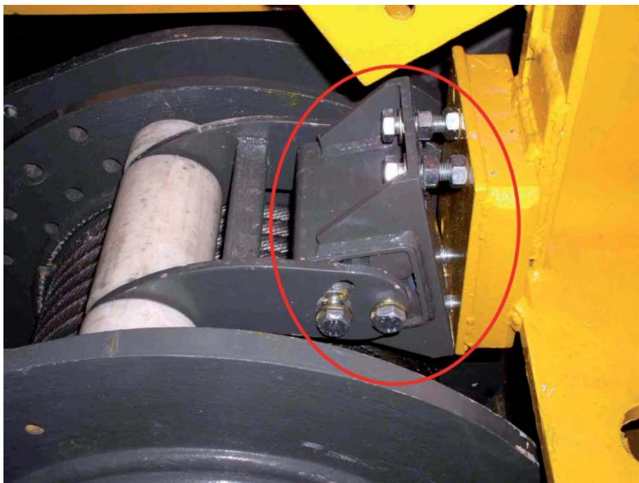
Rullo di guida della fune, equipaggiato con elemento tensionatore ROSTA
