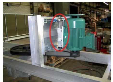
Trasmissione con ventilatore per scambiatore di calore, montaggio base motore ROSTA verticale tipo MB 50 x 200 (3 cinghie SPB)
