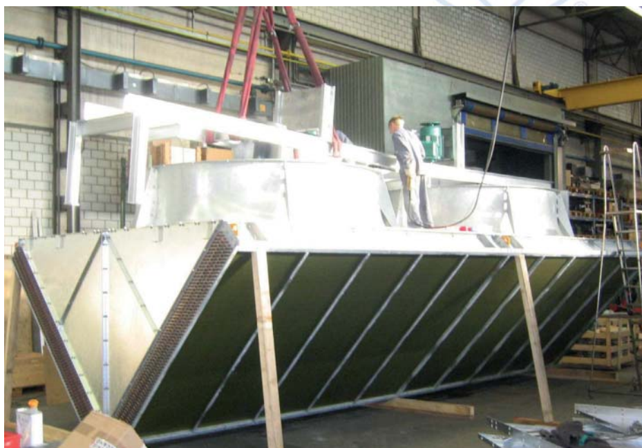
Scambiatore di calore a doppio blocco ECODYNE (montato a «V») con 2 ventilatori direttamente montati
