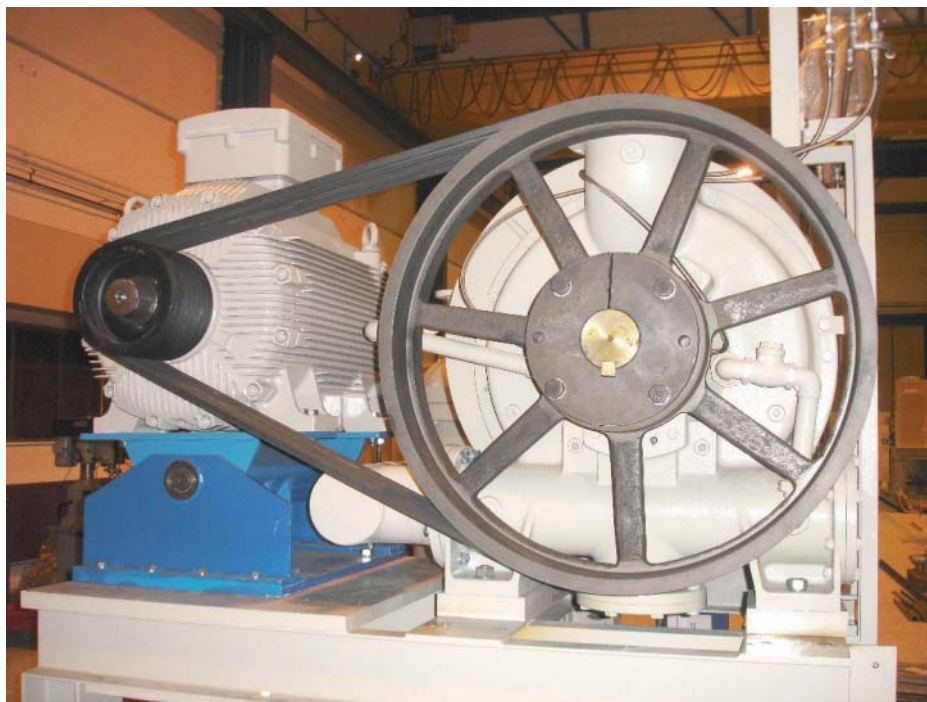
Motore da 250 kW per pompa ad anello per fluidi su Base Motore ROSTA tipo MB 100
