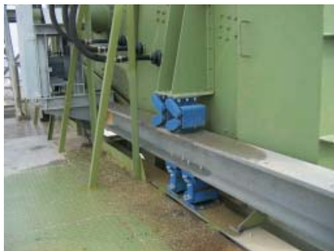
Fig. 2: Vaglio di drenaggio per ghiaia con telaio oscillante di contrasto montato su elementi ROSTA tipo AB ed AB-D.
