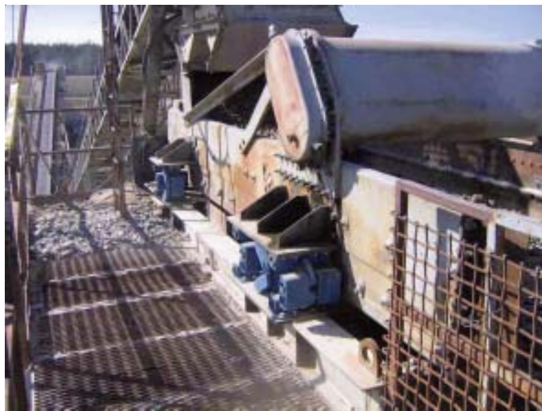
Fig. 1: Vaglio ad oscillazioni lineari montato su elementi ROSTA tipo AB e posato in una struttura in acciaio particolarmente alta.
