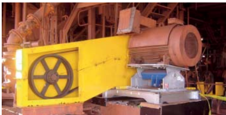
Basi motore ROSTA tipo MB 100 con motore da 220 kW per pompa centrifuga Warman (Foto: BHP Billiton-Mining, Australia)
