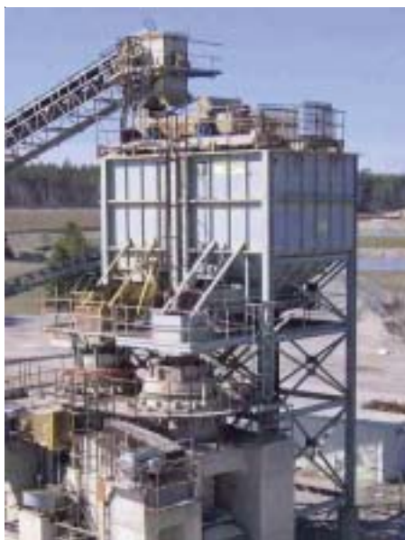
Fig. 1: Vaglio ad oscillazioni lineari montato su elementi ROSTA tipo AB e posato in una struttura in acciaio particolarmente alta.
